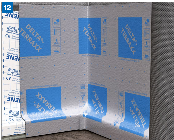
(obr. 12) Pri výške izolovanej steny do max. 2,3 m sa odporúča suterénnu stenu pásom vodorovne „obaliť“ a mechanicky pás fixovať v hornom plochom okraji. To ušetrí 50 % času na pokládku.
