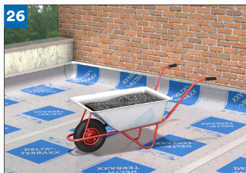
(obr. 26) Pri použití fólie DELTA®-TERRAXX pod násypom strešného substrátu je možné po položenej fólii bez problémov prechádzať stavebným fúrikom. Pokiaľ je už realizovaný čiastočný zásyp zeminou v hrúbke min. 20 cm, je možné po ploche počas doby výstavby prechádzať aj kolesovým nakladačom.
